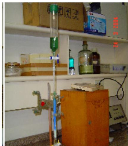
**Figura 3 – Retenção do cobalto em Cyanex 272 suportado em XAD-16**
