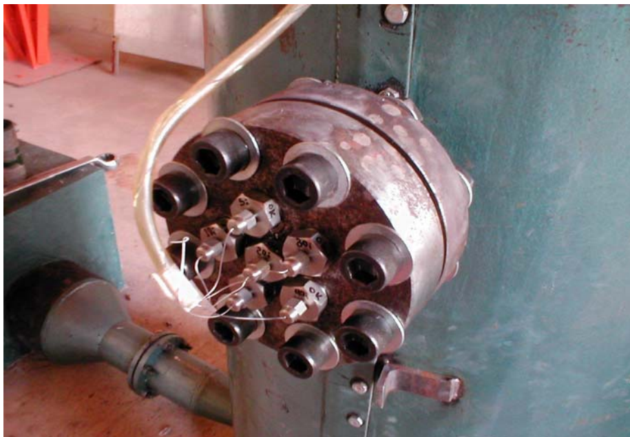
Figura 6 - Flange lateral com termopares para medição de temperatura interna do modelo.
