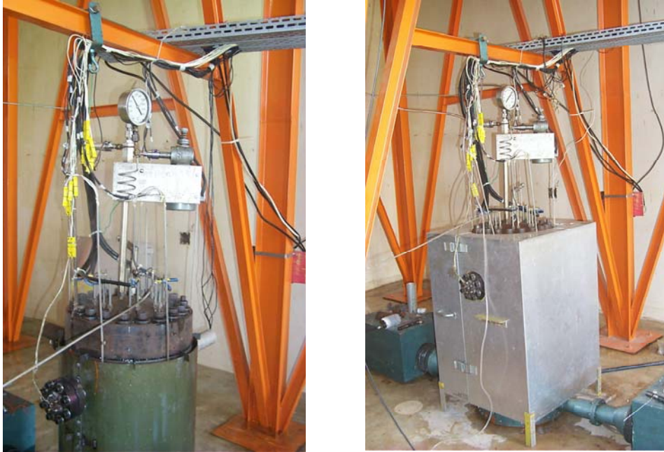
Figura 14 – Vaso de pressão instrumentado.
