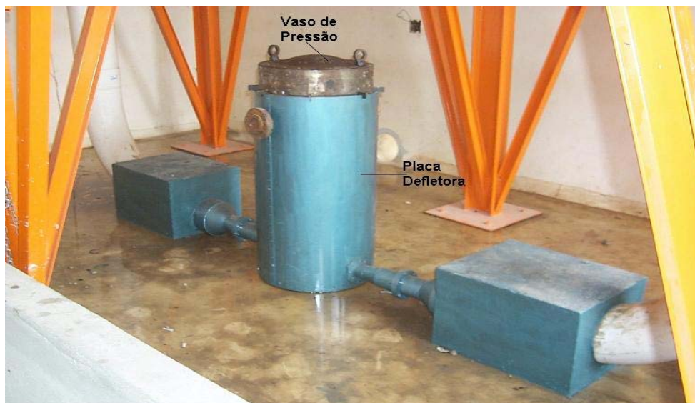
Figura 3 – Vista do piso da seção de testes antes da instrumentação do vaso.
