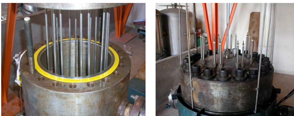
Figura 7 - Montagem das resistências elétricas no modelo.
