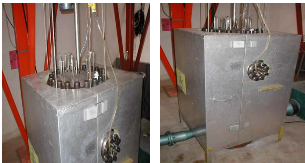
Figura 8 - Modelo do vaso de pressão isolado termicamente.
