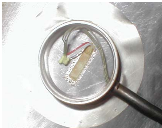
Extensômetro dentro da proteção de aço inoxidável
