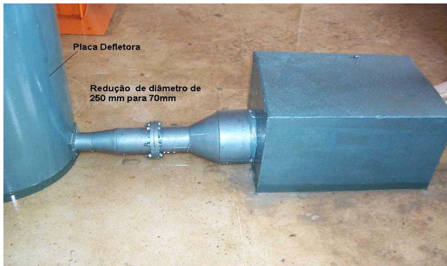
Figura 2 – Redução dos diâmetros dos tubos de injeção de água na placa defletora.
