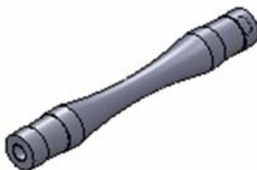
Figura 2. Corpo-de-prova utilizado nos ensaios de fadiga.
