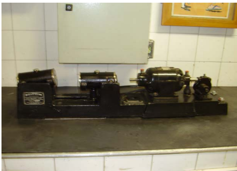
Figura 1. Máquina flexo-rotativa para execução dos ensaios de fadiga.
