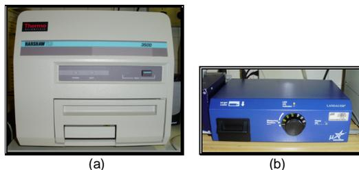
Figura 1. Sistemas leitores utilizados em (a) TL e (b) LOE.
