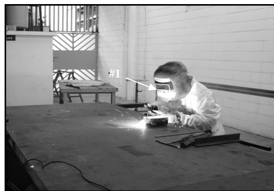
Figura 1: Posição dos conjuntos (cartão+lâmina+filtro), na máscara facial do soldador, durante 2 min de soldagem elétrica.
