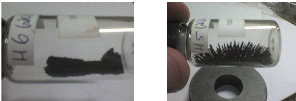
Figura 1. Pó de magnetita obtido da reação dos íons de \text{Fe}^{2+} com íons de \text{OH}^- exposto a um ímã.
