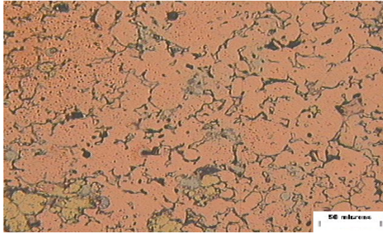
Fig.5 Liga Cu-1%Ni-0,5%Al, compactada a frio; sinterizada a 1053K por 5400s (Micrografia óptica).
