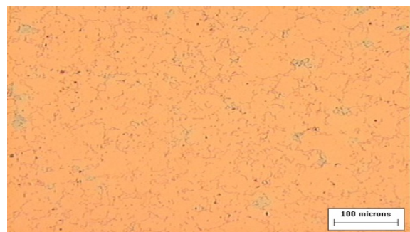
Fig.4 Liga Cu-1.0%Ni-0,5%Cr, compactada a frio; sinterizada a 1073K por 5.400s; homogeneizada a 773K por 172.800s (Micrografia óptica).
