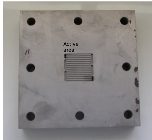
Figura 4: Placa de grafite coberta com níquel
