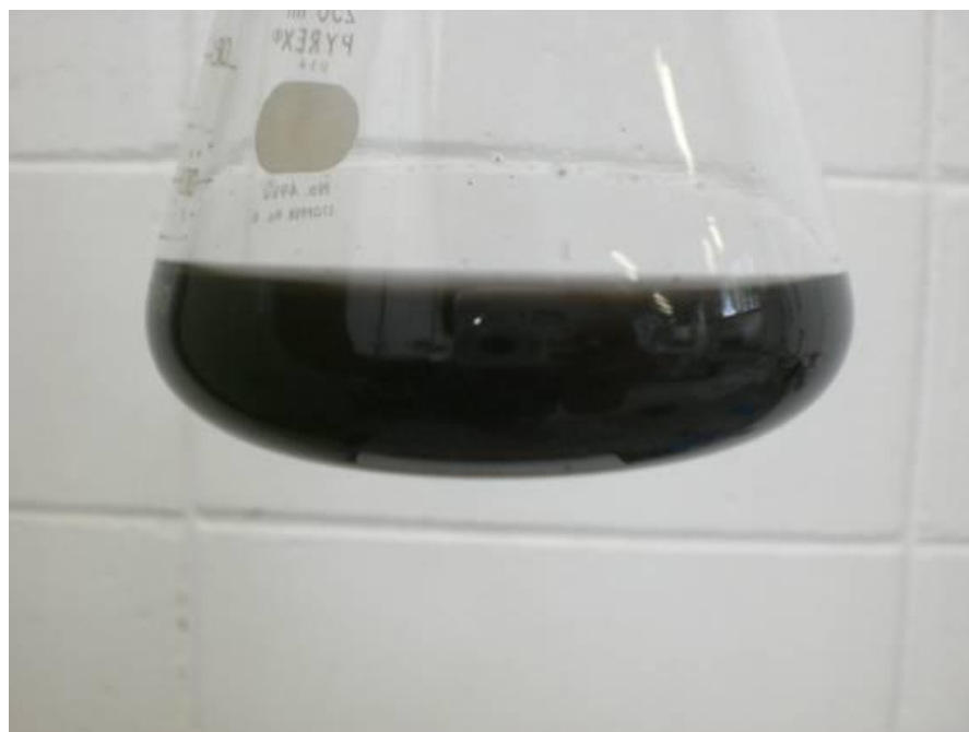
Figura 5 – Substância dissolvida em água obtida após eletrólise da água a partir da corrosão do eletrodo anódico de grafite
