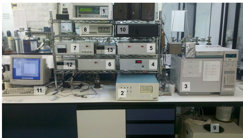
Figura 2: Sistema MAGICC 3/Brasil – Sistema de análise de GEE no LQA/IPEN. Onde: 1) Monitor LICOR ( \text{CO}_2 ); 2) Monitor de \text{CO}/\text{H}_2 Peak Laboratories ( \text{CO}/\text{H}_2 ); 3) Cromatógrafo gasoso HP ( \text{N}_2\text{O}/\text{SF}_6/\text{CH}_4 ); 4) Controlador de fluxo dos gases; 5) Válvula “Sample select e System select”; 6) sample/ \text{CO} reference; 7) Medidor de vácuo e Receptor de amostras; 8) Interface do cromatógrafo; 9) Banho resfriador; 10) Tela operacional; 11) Central única de processamento (CPU); 12) Interface do monitor de \text{CO}_2 ; 13) Interfaces das válvulas e do monitor \text{CO}/\text{H}_2 .
