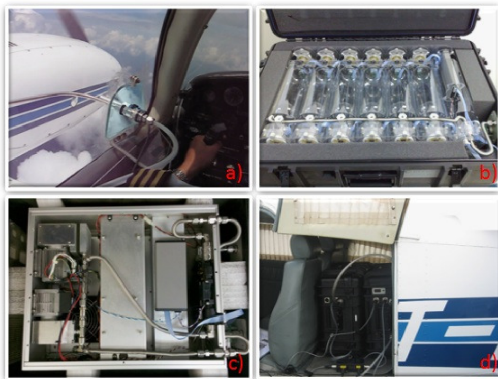
Figura 1: a) tubo coletor de ar na janela de mau tempo da aeronave; b) PFP aberta com 12 frascos de vidro; c) PCP aberta com dois compressores à esquerda e seu sistema de alimentação; d) espaço onde o sistema de amostragem de ar é acondicionado na aeronave (versão III).
