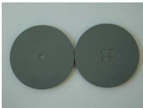
**Figura 1. Discos em poliestireno com cavidades nos centros, nas dimensões das amostras termoluminescentes.**
