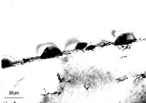
**Figura 3:** Microscopia eletrônica de transmissão do aço inoxidável DIN W. Nr. 1.4970 solubilizado e envelhecido a 600 °C durante 1000 horas, revelando M<sub>23</sub>C<sub>6</sub> nos contornos de grão.[3]
