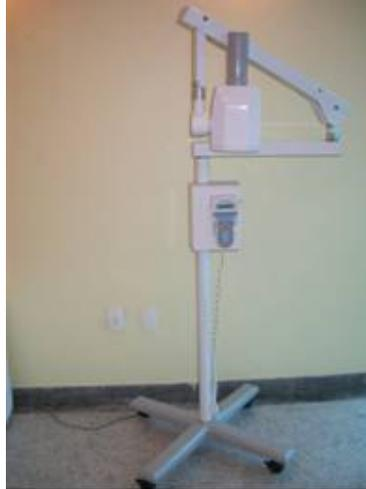
**Figure 1. Aparelho de raios X, marca Dabi Atlante, Spectro 70X, seletronic, com 70kVp, 8mA e filtração total equivalente a 2,71mmAl.**
