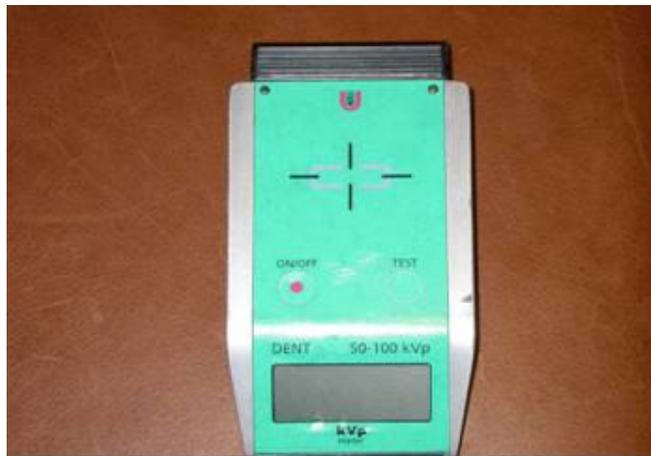
**Figure 2. Medidor de quilovoltagem (kVp), marca Unfors, e calibrado conforme laudo técnico do IEE/USP.**
