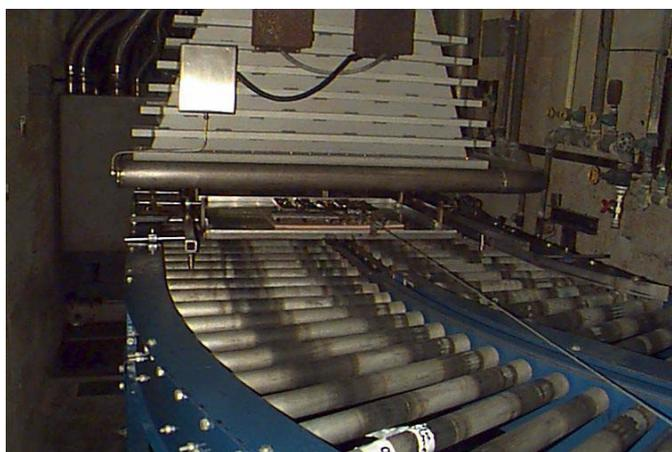
**Figura 1. Corpos-de-prova no acelerador de elétrons, mostrando no primeiro plano o sistema de varredura do feixe de elétrons.**
