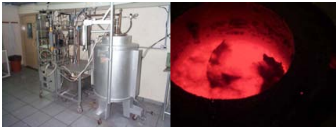
Figura 1: o sistema desenvolvido (esq.) e o reator com sal em processo de fusão.
