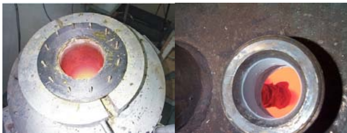
Figura 2: Reator aberto (esq.) e interior do reator com a lança imersa no sal (dir.).
