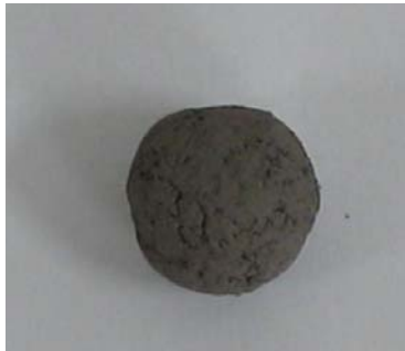
Figura 4a – Amostra com 10% de escória, antes da queima.
