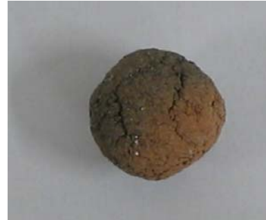
Figura 4b – Amostra com 10% de escória, após queima a 1170°C.
