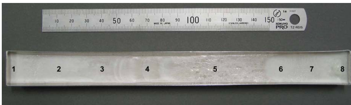
Figura 1: Lingote obtido pela técnica de refino por zona, identificando as regiões de 1 a 8, de onde foram retiradas as amostras para caracterização.
