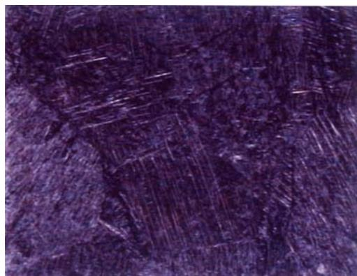
Figura 8: Imagem em campo escuro da amostra da liga Ti-6Al-4V tratada termicamente a 1000 C por 1 hora e resfriada na água, evidenciando grãos  $\beta$  primários (aumento 450X).
