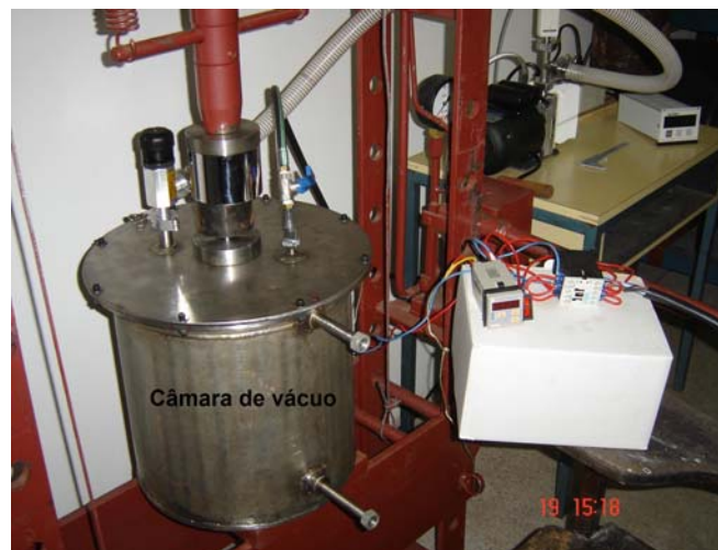
Figura 3. Fotografia geral do equipamento de conformação mecânica com a câmara de vácuo.
