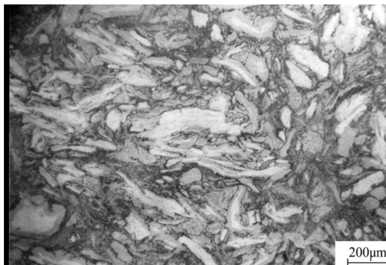
Figura 7. Micrografia ótica do material conformado (amostra com ataque).
