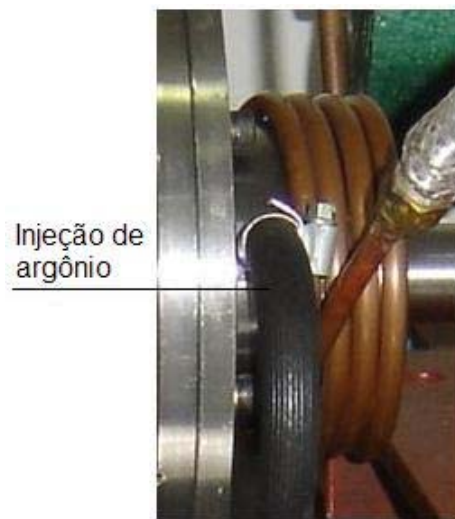
Figura 1. Fotografia apresentado detalhe da injeção de argônio no recipiente de moagem.
