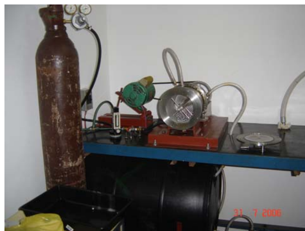
Figura 2. Fotografia geral do equipamento de moagem e os acessórios de resfriamento e injeção de gás.
