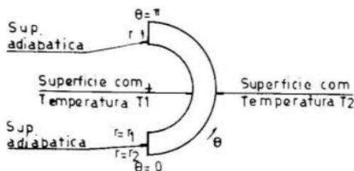
Figura 2 Geometria do cilindro horizontal considerada no modelo
