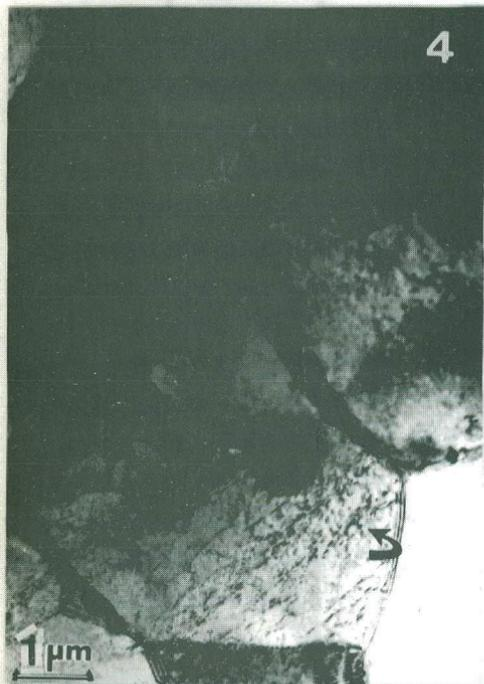
**Figura 4.** Liga 7050 SR solubilizada ( $480^{\circ}\text{C} \times 1\text{h}$ ), envelhecida ( $120^{\circ}\text{C} \times 72\text{h}$ ) e ensaiada em tração. Presença de precipitados finos (fases  $\eta$ , T, X) e bandas de escorregamentos.
