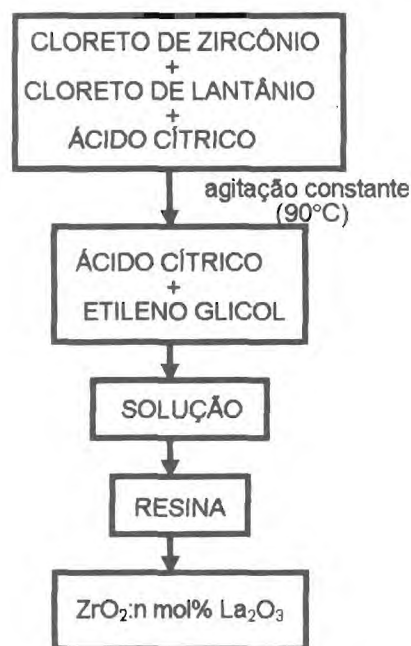
Fig. 1: Fluxograma da sequência experimental para a obtenção de ZrO_2:La_2O_3 pelo método dos citratos.
