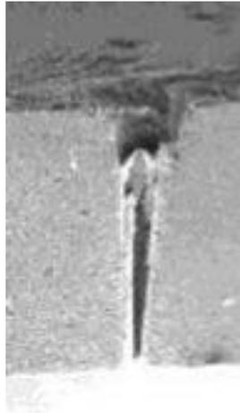
Figura 6 – Micrografia da seção de um furo obtido por percussão.
