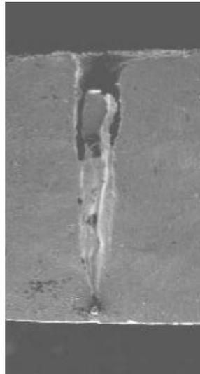
Figura 5 – Micrografia da seção da cratera feita por LSS.
