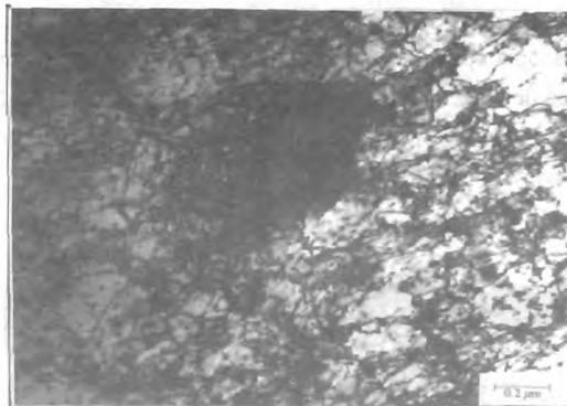
Fig. 6. Micrografia eletrônica de transmissão do material solubilizado, deformado e envelhecido, série DE, mostrando um arranjo de células incipiente, discórdâncias ancoradas a precipitados finos secundários, emaranhados de discórdâncias ao redor de um carboneto primário e precipitados secundários livres.
