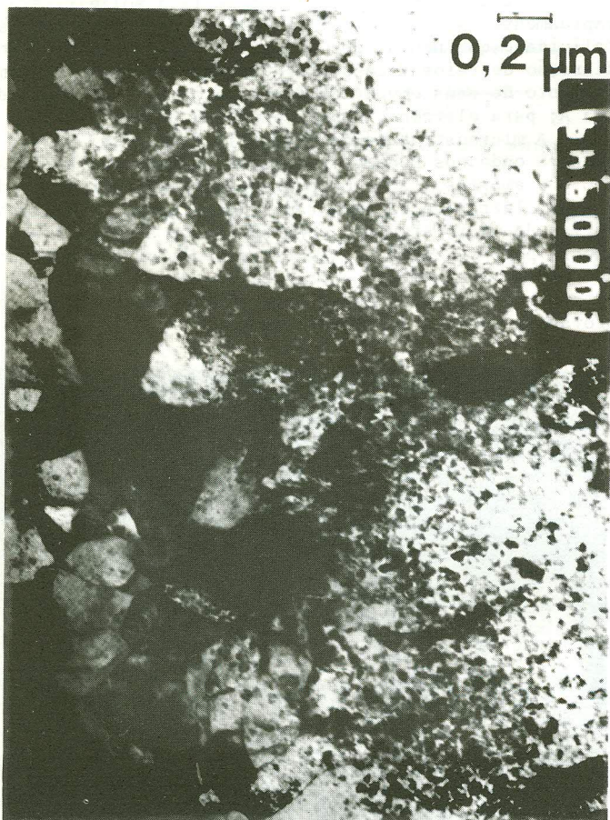
Figura 2. Micrografia eletrônica em campo claro mostrando a sobreposição dos microgrãos aos grãos maiores.
