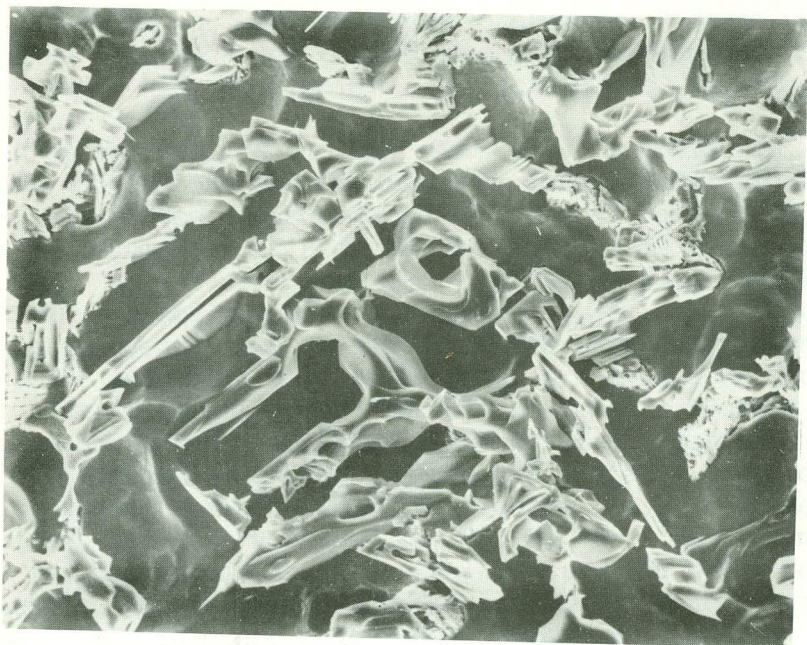
Figura 2 - Micrografia obtida por MEV, ataque profundo com NaOH 10%+Teepol. 200X.
