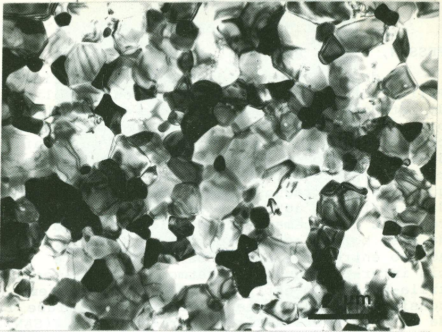
Fig.1 - Microestrutura de amostra de Al_2O_3/ZrO_2 .
