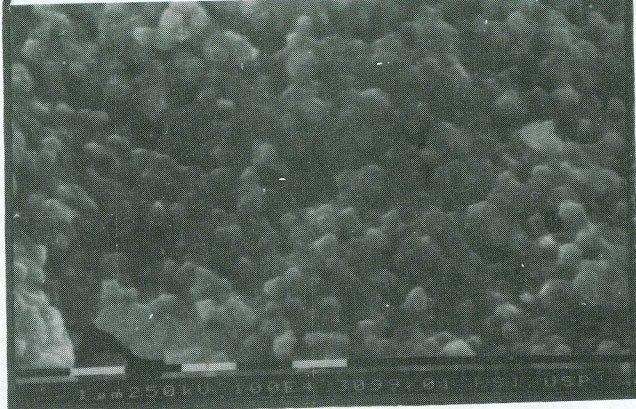
FIGURA 1: Micrografias eletrônicas de varredura de pastilhas sinterizadas a 1500^{\circ}\text{C}/1\text{h} de zircônia estabilizada com: (a) 5 mol % de ítria; (b) 2 mol % de ítria; (c) 3 mol % de ítria.
