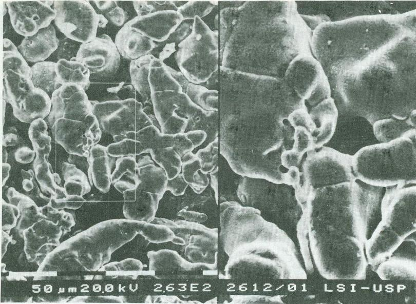
**Fig.1** Micrografia eletrônica de varredura mostrando o filtro preparado com o pó fino (porosidade interconectada  $\epsilon_i = 0,29$ ).
