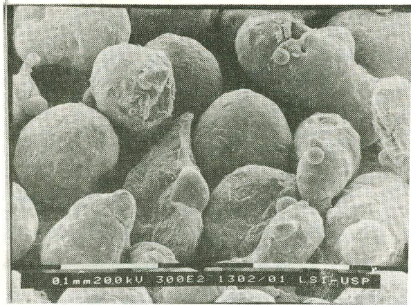
Figura 11. Micrografia de um pó com DA=3,54 \text{ g/cm}^3 .
