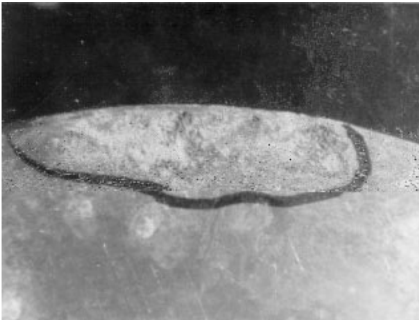
FIG. 5.14. Coupon 6061/08, galvanic corrosion (6 ×).
