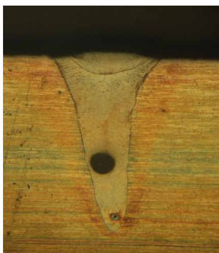
Figura 5. Micrografia do metal de solda com a presença de vazio. MO.
