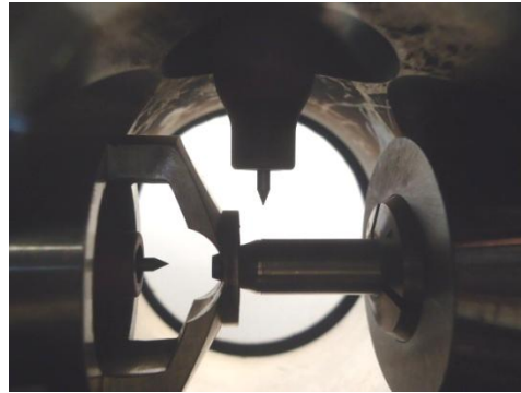
Figura 2: Imagem do interior da câmara de soldagem com eletrodo de tungstênio posicionado sobre a junta. Fonte: autor
