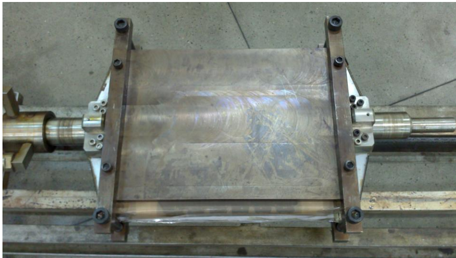
Figura 2: conjunto molde e placas de prensagem.
