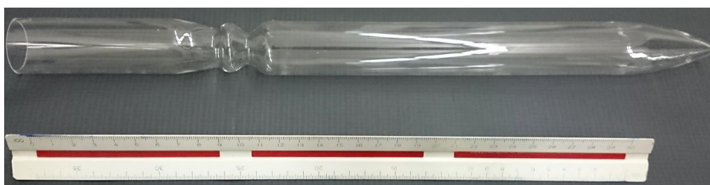
Figura 1: Cadinho com configuração geométrica apropriada ao crescimento de cristais pela técnica de Bridgman.
