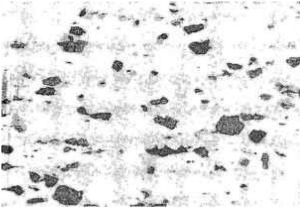
Fig. 4 — Microestrutura de seção transversal de núcleo de chapa, obtida pelo processo de moldura, contendo 30% U_3O_8 , depois de submetida a 1000 ciclos. Notar a inexistência de reação. 80 X.
