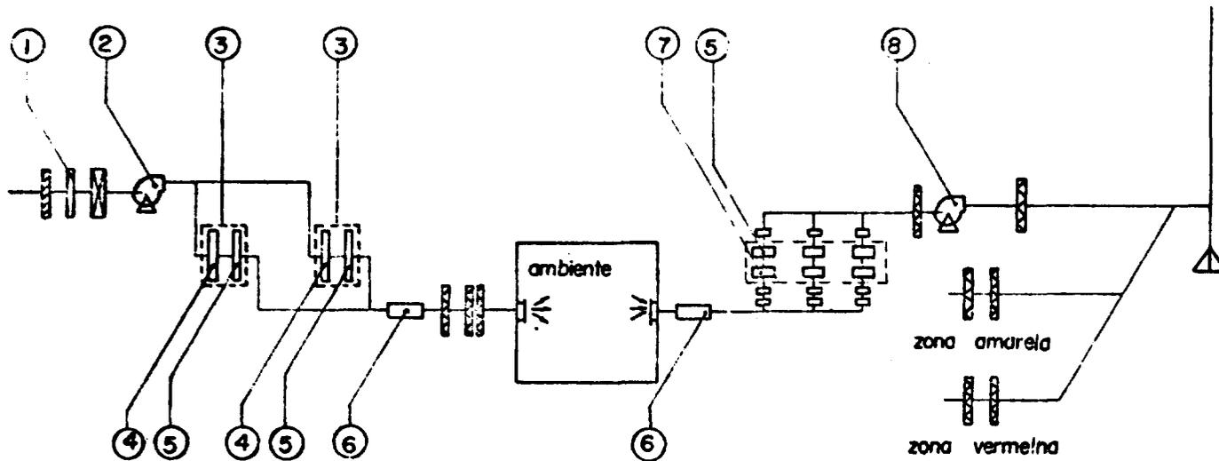
Figura 5 – Esquema Geral da Ventilação da Zona Verde
