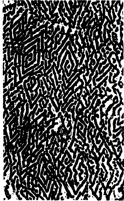
Figura 9 – Morfologia eutética num corte transversal. Liga Al-19%U. Ataque: HF a 1%. Aumento: 500 X. Ampliação: 5 X.
