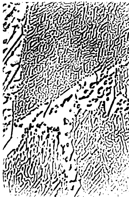
Figura 16 – Secção transversal de estrutura eutética em solidificação unidirecional obtida com materiais de maior pureza. R = 6 cm/h. Liga Al 13,3%U Polimento eletrolítico. Aumento: 500 X Ampliação: 2,5 X.
