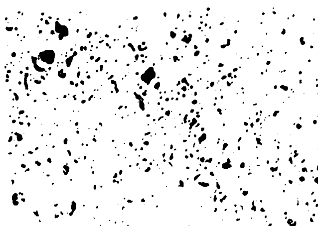
Figura 4 – Micrografia de secção transversal de pastilha de UO_2 (ATCU), mostrando o aspecto de distribuição de porosidade. Pastilha sinterizada por 3 horas a 1675^\circ C . Aumento: 500 X
