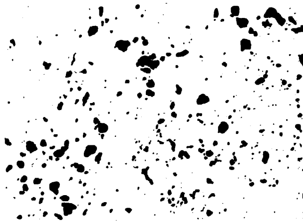
Figura 6 – Micrografia de secção transversal de pastilha de UO_2 (ATCU), mostrando o aspecto de distribuição de porosidade. Pastilha sinterizada por 1 hora a 1675^\circ C . Aumento: 100 X
