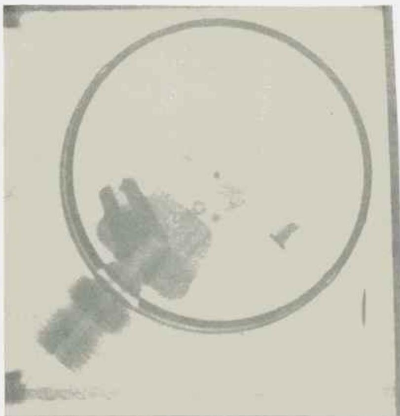
**Figura 3.2** – Neutrografia de um Manômetro.
