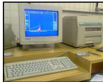
Fig.3. Sistema de leitura TL - leitora TL *Harshaw* e computador com o sistema de aquisição de dados TLDSHELL.
