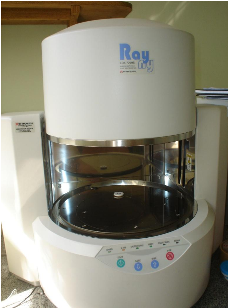
Figura 4 – Fluorescência de Raio X - EDXRF (foto de Ana Paula G. Martins – 20/09/2008)
