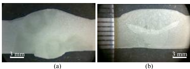
Figura 3 - Ensaio macrográfico da amostra soldada com eletrodos revestidos SMAW (a) e com o processo combinado SMAW+FCAW-S (b)
