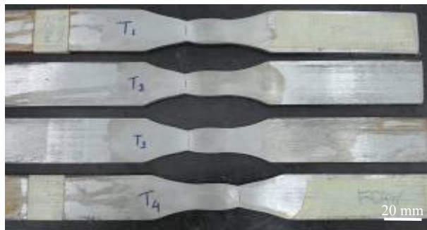
Figura 5 - Corpos de prova rompidos após o ensaio de tração
