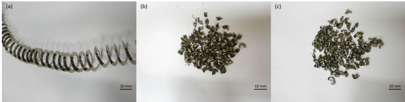
Figura 8. Formas do cavaco. (a) Helicoidal tipo arruela longo (ferramenta sem textura); (b) Arco solto (ferramenta com textura tipo A); Arco solto (ferramenta com textura tipo B).
