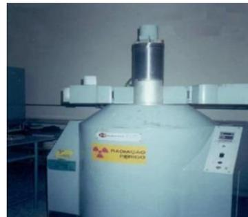
Figura 1: Fonte de <sup>60</sup>Co do CTR/IPEN utilizada para as irradiações das amostras.
