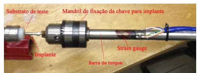
Figura 1. Imagem da barra de torque original do protótipo de dispositivo para medição de micro-torques, com indicação dos componentes à ela acoplados [2].
