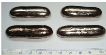
FIGURA 1 – Barras de Zircaloy-4 obtidas na fusão destinadas à tratamento térmico e laminação.
