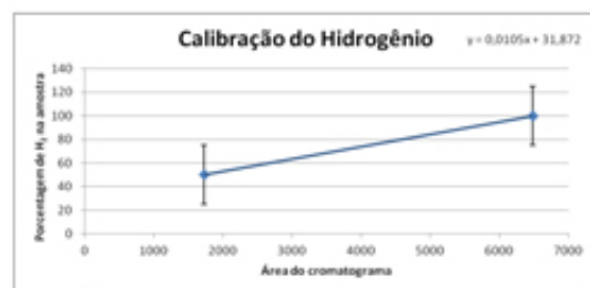
Figura 3 – Gráfico que relaciona a porcentagem de Hidrogênio e sua área no cromatograma.
