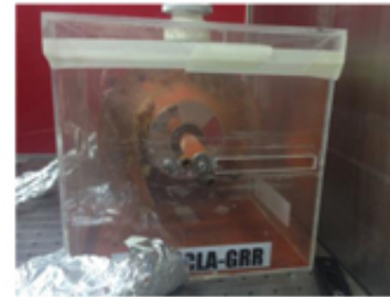
Figura 4 – PR após incidência do laser em sua superfície, pode-se ver a tinta contaminada no fundo da caixa.
