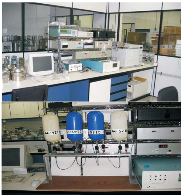
Figura 2 - Sistema MAGICC 3 Brasil – Sistema de análise de Gases de Efeito Estufa no LQA/IPEN acima e abaixo o sistema construído para a análise automática de 4 frascos
